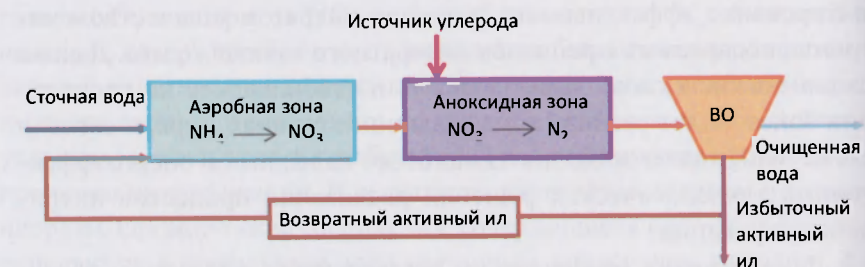
Рис. 2.22. Схема с пост-денитрификацией (Wuhrmann process)
