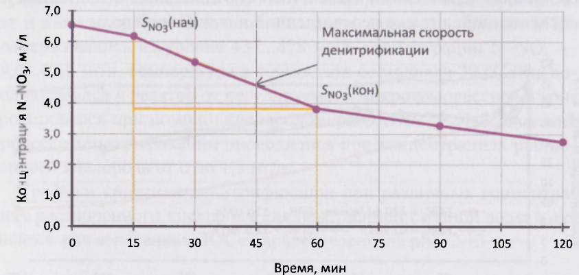
Рис. 2.11. Кинетика процесса денитрификации, реализованного на осветленной сточной воде и активном иле ЛОСст при отсутствии дефицита органических соединений
