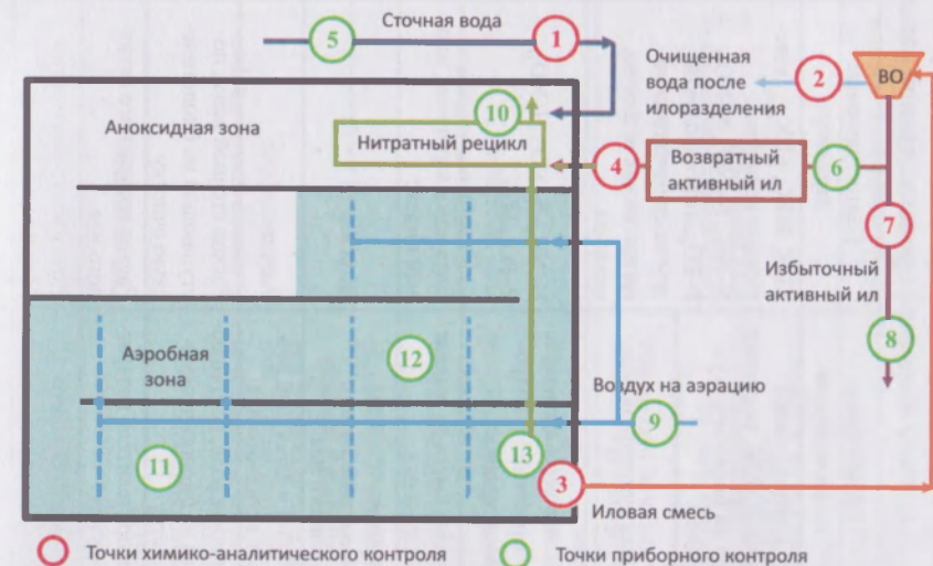
Рис. 2.28. Пример схемы аналитического и приборного контроля аэротенка, работающего по технологии нитри-денитрификации
