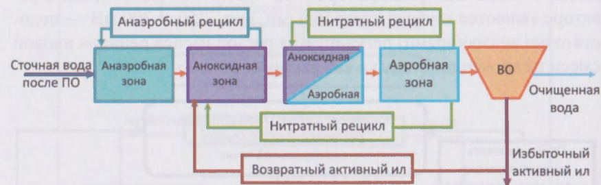
Рис. 4.14. Схема биологической очистки на очистных сооружениях западного Амстердама WWTP Amsterdam-West
