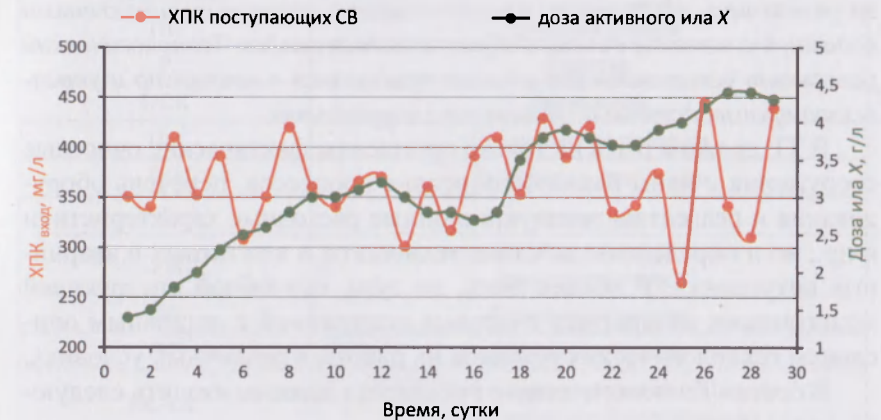
Рис. 5.20. Динамика дозы активного ила в ходе 2-го этапа технологического запуска аэротенка, работающего по технологии биологического удаления азота и фосфора по схеме УСТ
