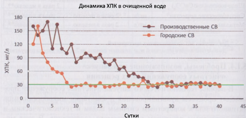
Рис. 5.11. Динамика ХПК в очищенной воде очистных сооружений, запущенных с помощью «затравочного» активного ила
