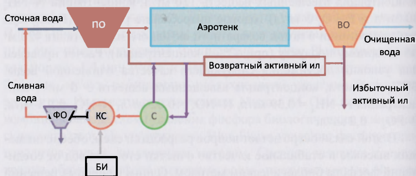
Рис. 3.21. Схема реализации процесса PhoStrip: ПО — первичный отстойник, ВО — вторичный отстойник, С — стриппер, КС — камера смешивания, ФО — «фосфорный отстойник», БИ — бункер с известью
