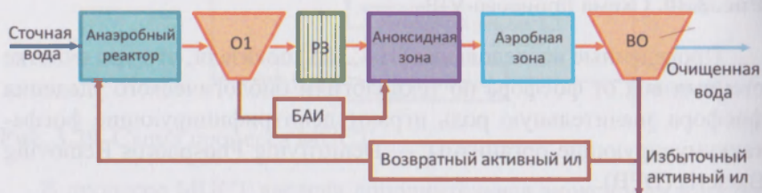
Рис. 3.31. Схема процесса DEPHANOX: O1 — отстойник 1-й ступени; РЗ — реактор с загрузкой; БАИ — байпасный активный ил
