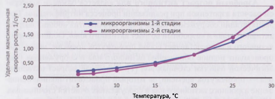
Рис. 2.6. Зависимость скоростей роста нитрифицирующих микроорганизмов 1-й и 2-й стадий процесса нитрификации от температуры сточных вод
